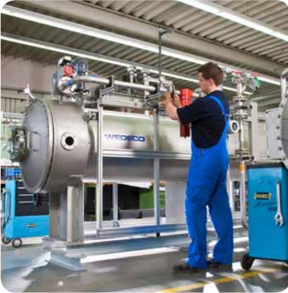
Abb. 1: Montage einer Wedeco-Ozonanlage
